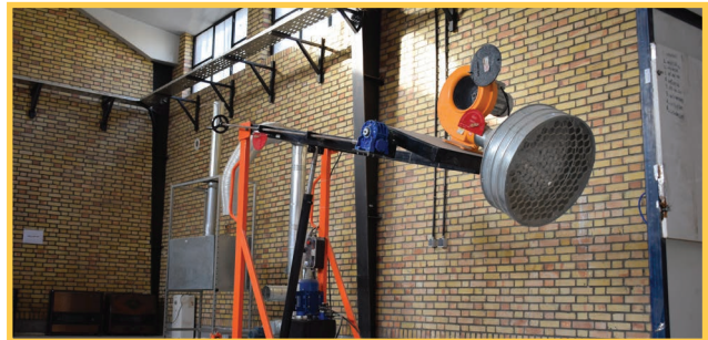
بستر آزمون بخاری- آزمون باد برای بخاری‌های تایپ C
