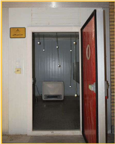
اتاق دربند شده جهت آزمون کاهش سطح اکسیژن
